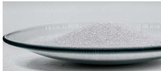
Trennhilfsmittel werden eingesetzt, um das Aneinanderhaften (Adhäsion) von flachen Werkstücken während des Prozesses zu vermeiden und unterstützen eine rundum gleichmäßige Bearbeitung. Es handelt sich dabei um kleine Kugeln oder Granulat aus Acrylpolymer.
