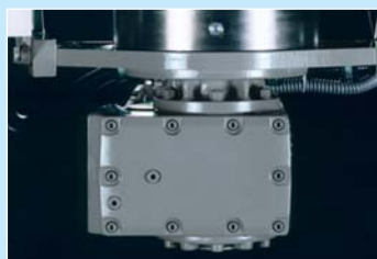
Die Speziallagerung (lebensdauer geschmiert) aus Standard-Bauteilen garantiert einen optimalen Rundlauf.
