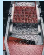
Separierung in 2 Ebenen; oben Werkstücke, unten Unterkorn.
